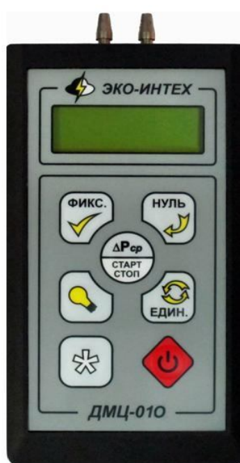
Манометр дифференциальный цифровой ДМЦ-01О
